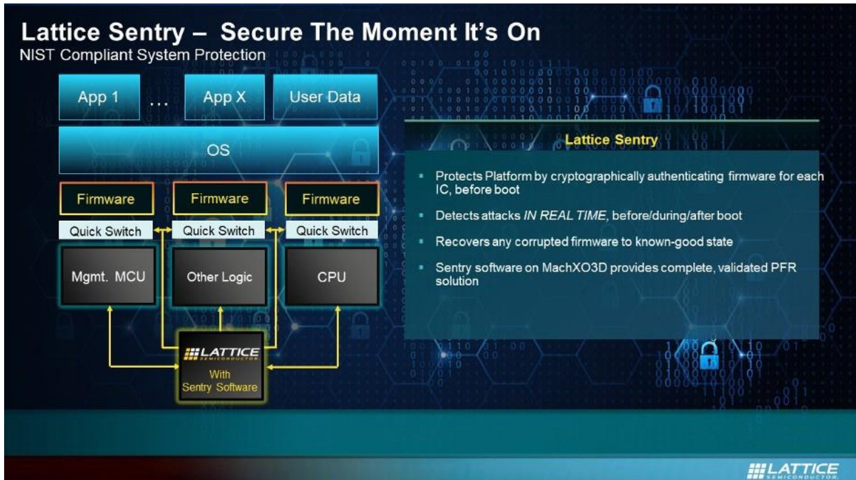
図 4: ブロック図に示すように、Lattice SentryベースPFRアプリケーションはシステム内の全ファームウェアをリアルタイムで保護可能
