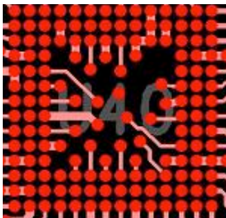
图2——8x8 mm，0.5 mm引脚间距，132球型CsBGA封装的MachXO PLD (LCMXO640-M132/MN132) 使用焊盘内过孔引出引脚布线的示例
